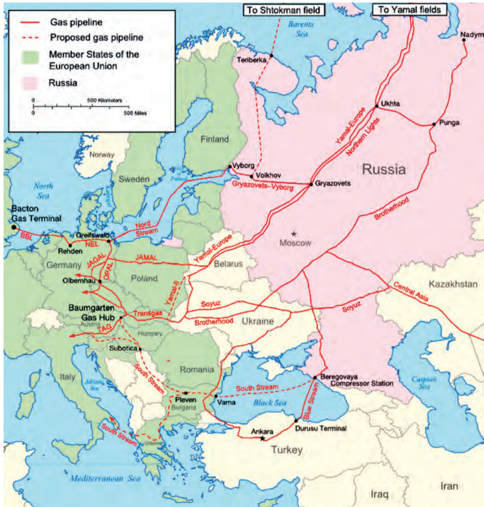
Abb.III.1.12 Verlauf osteuropäischer Gaspipelines
